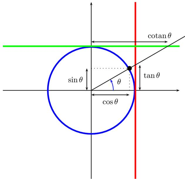
FIG. 2.1 – Cercle trigonométrique
