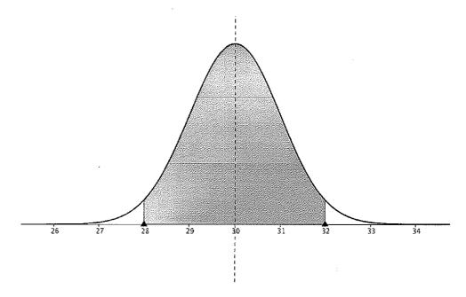
L'unité d'aire est choisie de façon à ce que l'aire sous la courbe soit égale à un et l'aire grisée est environ égale à 0,95 unité d'aire. La droite d'équation x=30 est un axe de symétrie de la courbe.
